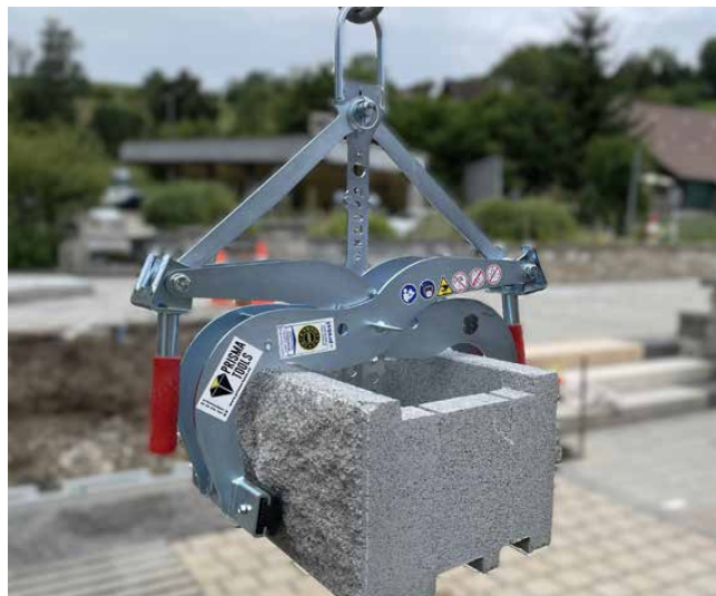
Illustration 5 : pose à l'aide de la pince TSZ-Uni
