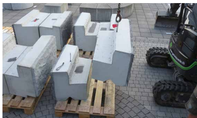
Illustration 21 : douilles de transport M16 montées en usine
