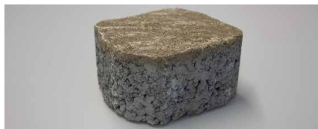
noyau en béton filtrant
