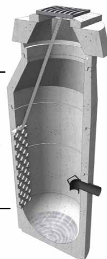
Coupe schématique AMFIX® Sortie amphibie intégrée dans un regard de chaussée
