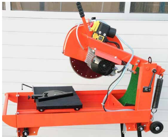
Figure 9 : machine à scier la pierre avec disque diamanté fermé.
