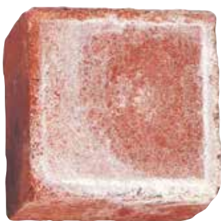
Pflasterstein mit starken Ausblühungen
