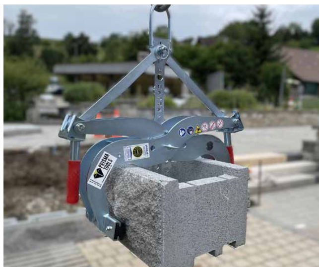
Illustration 5 : pose à l'aide de la pince TSZ-Uni
