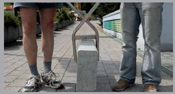
PINCE DE LEVAGE AVEC MÂCHOIRES EN CAOUTCHOUC
