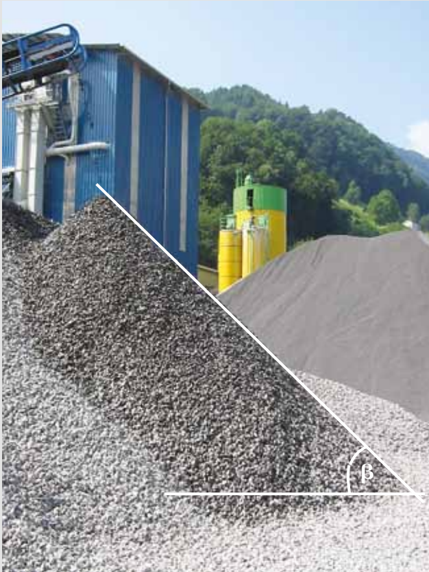
Natürlicher Böschungswinkel \beta
