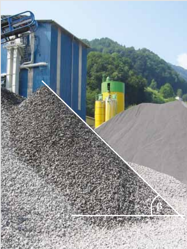
Natürlicher Böschungswinkel \beta
