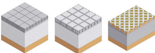
Bild 3: Gegenüberstellung Sicker-, Öko- und Rasengittersteine (v.l.n.r.)
