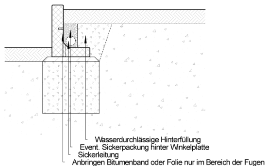
Bild 17: Mögliche Lage einer Sickerleitung
