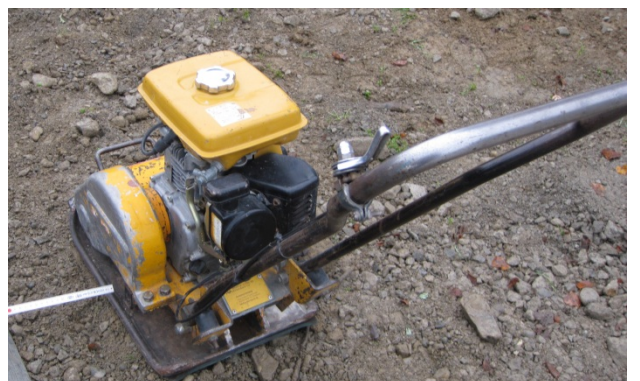
Bild 42: Verdichten nur mit sehr leichten Verdichtungsgeräten
