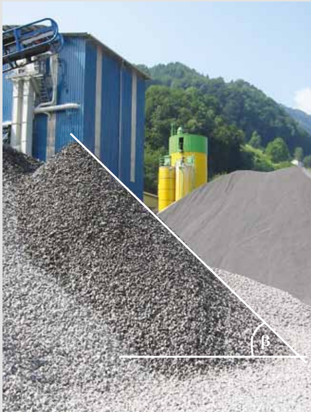
Natürlicher Böschungswinkel \beta
