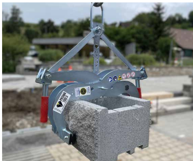
Bild 5: Versetzen mit Trittstufenversetzzange TSZ-Uni
