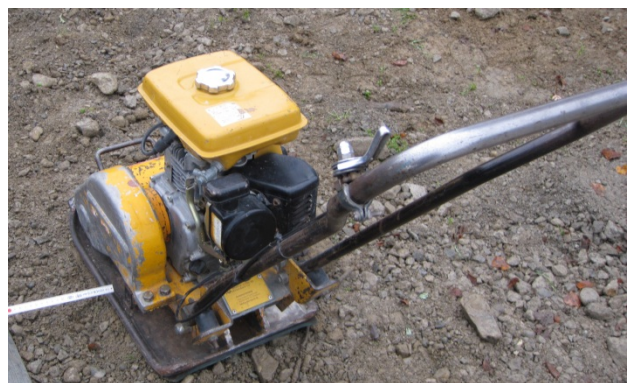
Bild 42: Verdichten nur mit sehr leichten Verdichtungsgeräten
